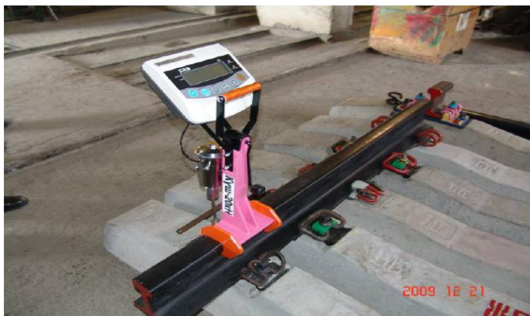
Рисунок 4.3 – Прибор «Күш-20кН» для определения усилия прижатия всех видов упругих клемм
