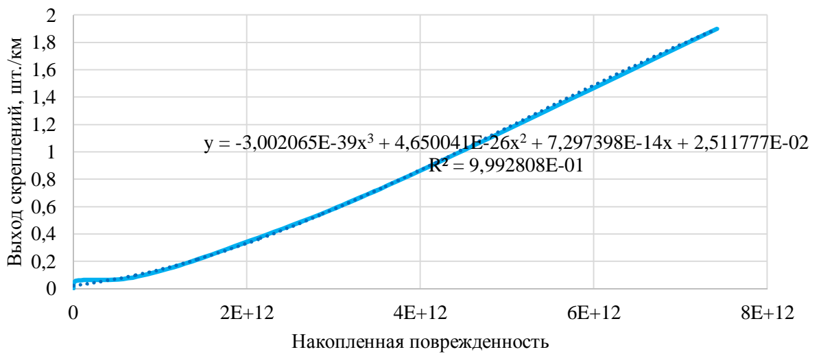
Рисунок 4.7 – График зависимости выхода креплений
